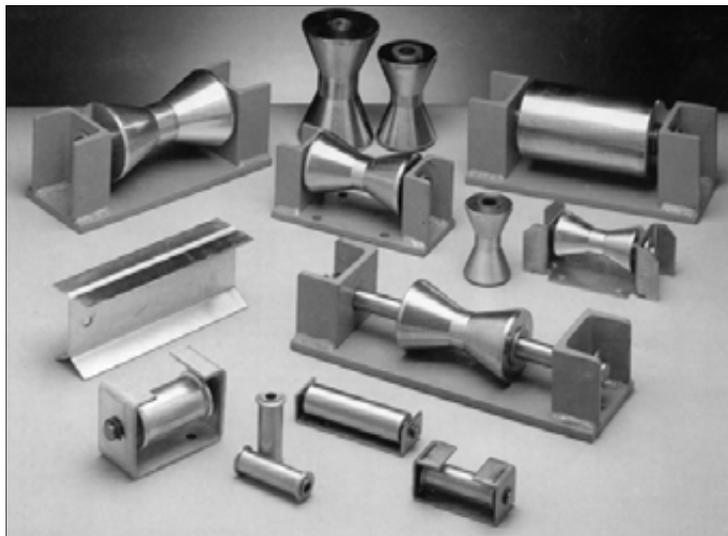
Questi supporti a rullo sono realizzati in acciaio al carbonio con perno inox AISI 304 e boccole auto lubrificanti a base di P.T.F.E.
