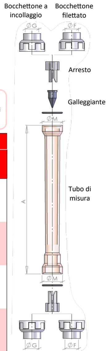
**PORTATE DI RIFERIMENTO E DIMENSIONI DI INGOMBRO ASAMETRI IN PVC**
