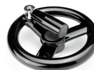
Volantino a razze mozzo affiorante superiormente e manopola girevole ribaltabile a scatto Art. VRA/MR ø 150/200
