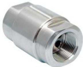
Valvola di ritegno assiale in acciaio inox AISI 316 + PTFE. Corpo ricavato dal pieno con otturatore semisferico nei diametri 3/8" - 1/2" - 3/4" - 1" ed otturatore piano nei diametri 1 1/4" - 1 1/2" - 2"
