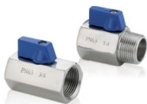
Valvola a sfera "MINIGLOBE" di intercettazione "ON-OFF", monoblocco a passaggio ridotto filettatura FF EN 10226-1 (ex ISO7/1), leva in alluminio verniciato, corpo, ghiera e sfera in AISI 316, stelo AISI 304, guarnizioni PTFE, Oring in FPM. Serie PN 63 - Temperatura: -25° C + 180° C.
