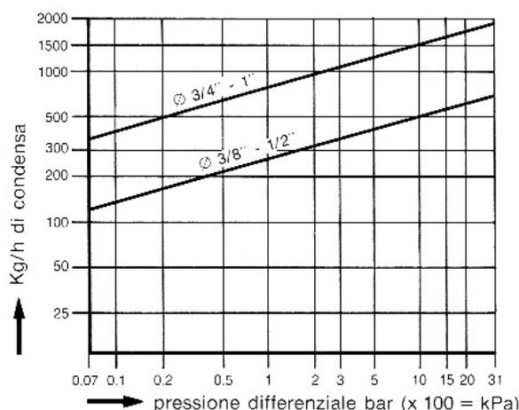
**SCARICATORE DI CONDENSA TERMODINAMICO
