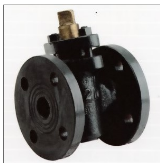
RUBINETTO A MASCHIO IN GHISA A DUE VIE CON PREMISTOPPA E MASCHIO IN BRONZO PN 16 DN 20 - 150
